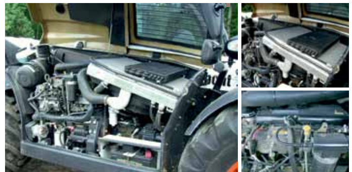
Der Motor ist seitlich montiert und bei geöffneter Motorhaube sind alle Wartungspunkte (re.u.) gut erreichbar. Der Lüfter saugt die Luft von oben durch das Kühlerpaket (re.o.). Das verringert die Schutzablagerung am Schutzgitter. Durch die Lüfterumkehrung ist eine Reinigung aber auch sehr schnell geschehen.
