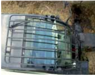
Das Schutzgitter vor der Frontscheibe ist optional zu haben, um den Durchschlag eines schweren Objektes zu verhindern. Wobei aber die Kabine selbst auch den ROPS-FOPS-Status voll erfüllt.
