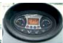
Die Bedienelemente in der Kabine sind logisch angeordnet. Der rechte Arm verbleibt bei der Arbeit fast nur auf der Bedienarmlehne. In dem kleinen Armaturenfeld findet man alle wichtigen Daten. Darunter liegt die Anzeige für die Überlastsicherung.
